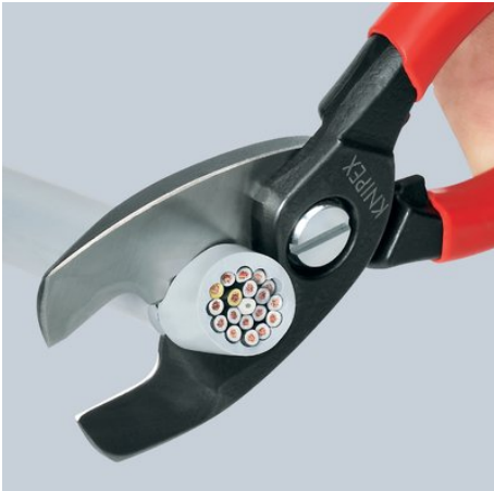
Coupe définitive : une fois la gaine du câble coupée dans le profil avant, on coupe les conducteurs dans le profil arrière. Coupe préliminaire à l'avant, coupe définitive à l'arrière – la coupe est plus facile.
